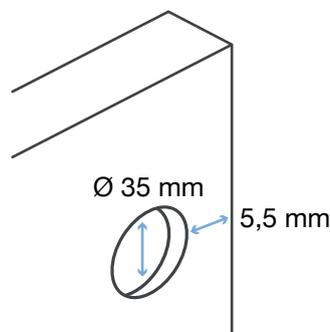
Les trous de charnières sont par défaut en retrait de 5,5 mm et ont un diamètre de 35 mm. Si vous souhaitez d'autres dimensions pour le trou de charnière, vous pouvez les indiquer dans le configurateur.
