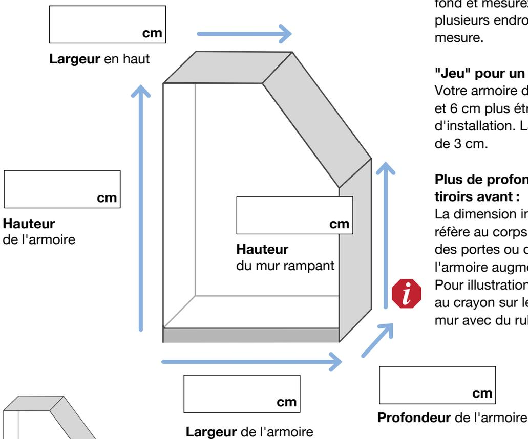
À partir d'une hauteur de 262,2 cm, nous fabriquons votre armoire avec une plinthe, afin que vous puissiez mieux l'ajuster et l'aligner parfaitement.
